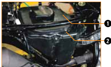
Fig N°20 Caja filtro de aire
