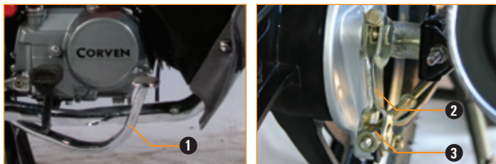
Fig.24 Pedal de freno y leva de freno trasero
